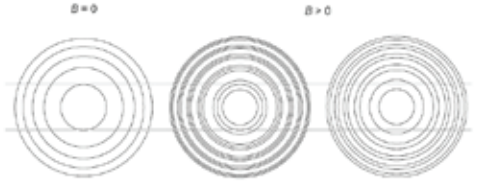
Interferenzmuster des Etalons (links), Triplet-Aufspaltung beim transversalen (Mitte) und Dublett-Aufspaltung beim longitudinalen Zeeman-Effekt (rechts)
