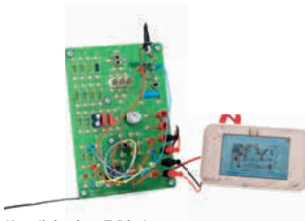
Kennlinie einer Z-Diode
