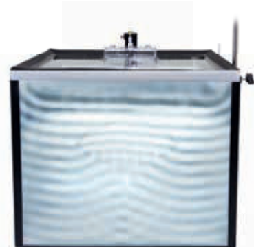
Brechung von Wasserwellen an einer Sammellinse
