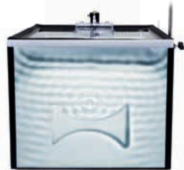
Reflexion von Wasserwellen an einem „Hohlspiegel“
