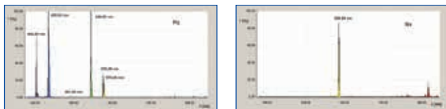
Linienspektren von Hg (Hochdruck) und Na, aufgenommen mit dem digitalen Spektrometer
