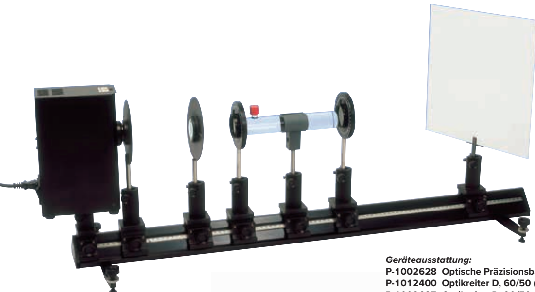
Bestimmung des Drehwinkels optisch aktiver Substanzen
