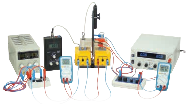
Experimenteller Aufbau: Hall-Effekt an Metallen
