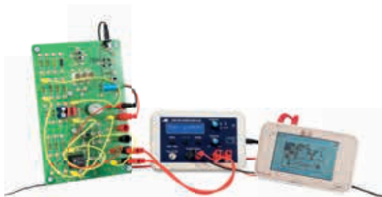
Aufzeichnung der Resonanzkurve eines RLC-Serienschwingkreises
