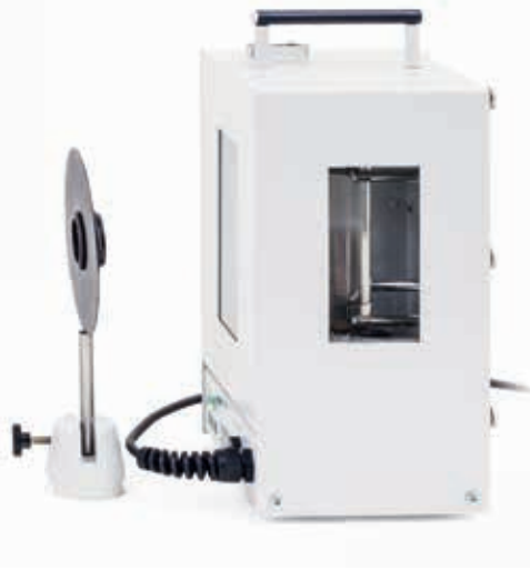
Experimenteller Aufbau zu Durchleuchtung der Natrium-Fluoreszenz-Röhre mit gebündeltem weißem Licht
