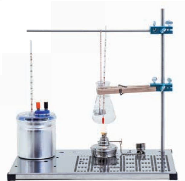
Spezifische Wärmekapazität von Metallen
