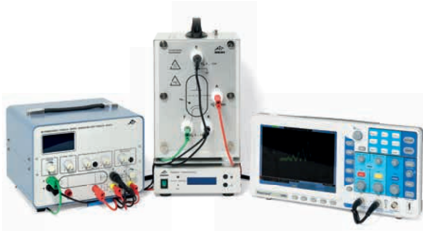
Franck-Hertz-Experiment mit Neon
