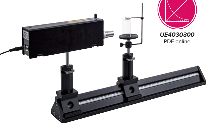
Erzeugung von Zweistrahlinterferenz mit einem Fresnel'schen Biprisma
