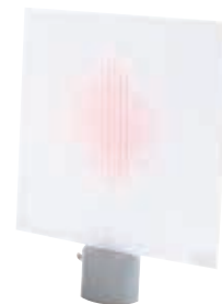
Erzeugung von Zweistrahlinterferenz mit einem Fresnel'schen Biprisma
