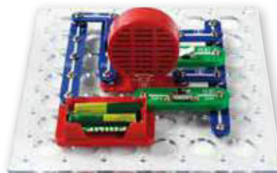
Experiment: Türklingel mit Druckschalter
