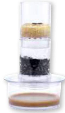
minimaler zweistufiger Filter mit Sand und Aktivkohle
