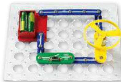
Experiment: Strom erzeugt Bewegung
