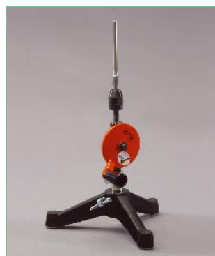
701 Schwungmaschine für Rotations- modelle, handbetrieben. Rotation device for rotation models, manual operation.
