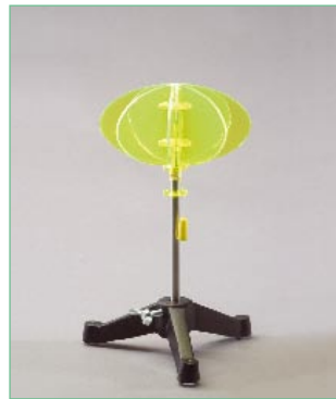
689 Rotationsmodell für ein abgeplat- tetes Ellipsoid, zur Demonstration der Guldinschen Regel. Oblate ellipsoid (or spheroid) of revolution to demonstrate the theorem of Pappus (or Guldin).
